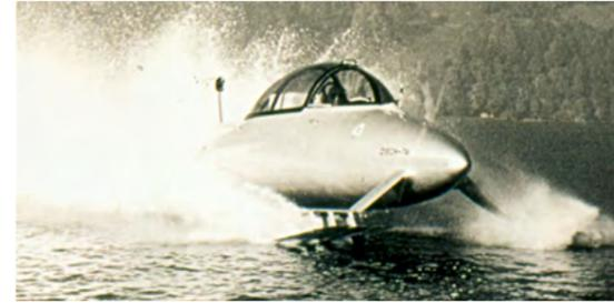
**1974** Konstruktion des zweiseitigen Gleitflächenbootes ZISCH 74 mit 265-PS-4-Scheiben-Kreiskolbenmotor im Auftrag von Dr. Wankel. Erfolgreiche Erprobung auf dem Vierwaldstättersee im Sommer 1975. Das Experiment wurde nicht weiterverfolgt.
